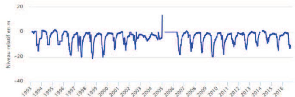
Figure 31 : Suivi piézométrique de la nappe de l'Infra-Toarcien (FRFG078) – Piézomètre des Outres 2 (06367X0138)
